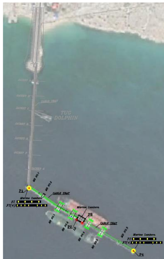
شکل ۱۴- جانمایی چراغ‌های دریایی اسکله نفتی لاوان
