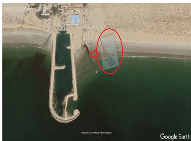
شکل ۹- مقایسه عکس هوایی پخش شوری به تاریخ ۲۰۱۳/۰۴/۰۳ با خروجی مدل کورمیکس
