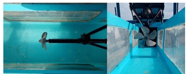
شکل ۳- نمای از روبه‌رو و بالای یک پروانه نیمه مغروق در مقطع تست
