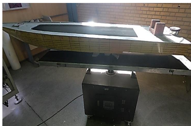
شکل ۵- مدل شناور و در حال اندازه گیری ممان اینرسی
