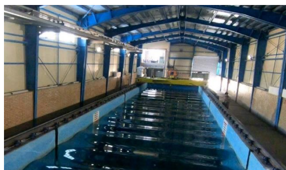
شکل ۹- موج منظم تولیدی توسط موج ساز با ارتفاع ۱۰ سانتیمتر
