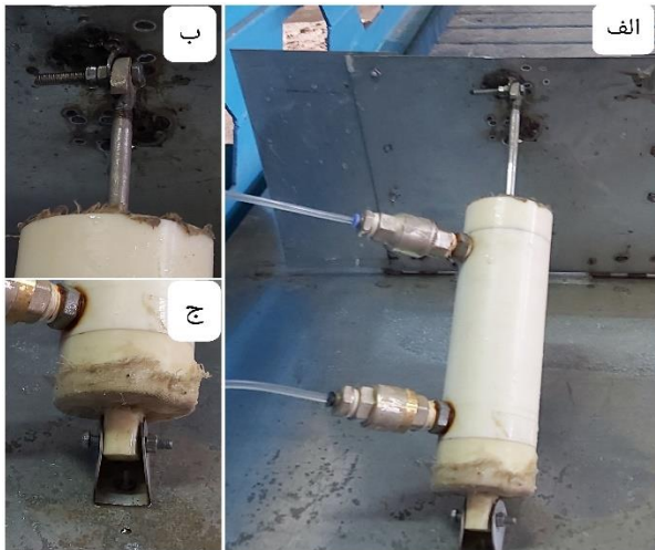
شکل ۷ الف: نمایی از مبدل انرژی موج و نحوه اتصال آن به، ب: صفحه ج: کف
