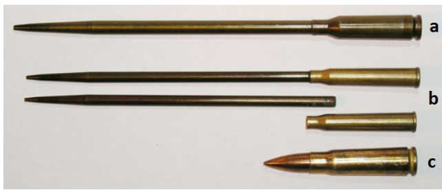
شکل (۱) (a,b) گلوله‌های سوپر کاویتاسیون (با قطر ۴/۴۵ و ۵/۴۵ میلی‌متر) و (c) گلوله معمولی سلاح کلاشنیکف (با قطر ۷/۶۲ میلی‌متر) [۱]
