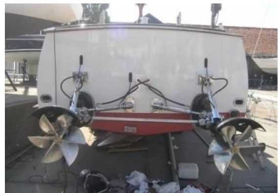
شکل ۱- شناور تندرو مجهز به سامانه رانش پروانه نیمه‌مغروق ۳
