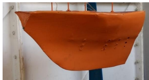
شکل ۴- مدل ساخته شده از شناور
