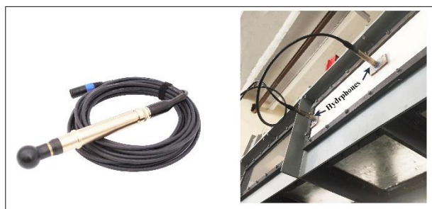
شکل ۱۴ - هیدروفون TC4042 و جانمایی تجهیزات تست
