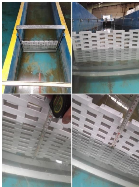
شکل ۵- استقرار مدل سازه‌ی موج‌شکن دیوار بلوکی در بدنه‌ی فلوم
