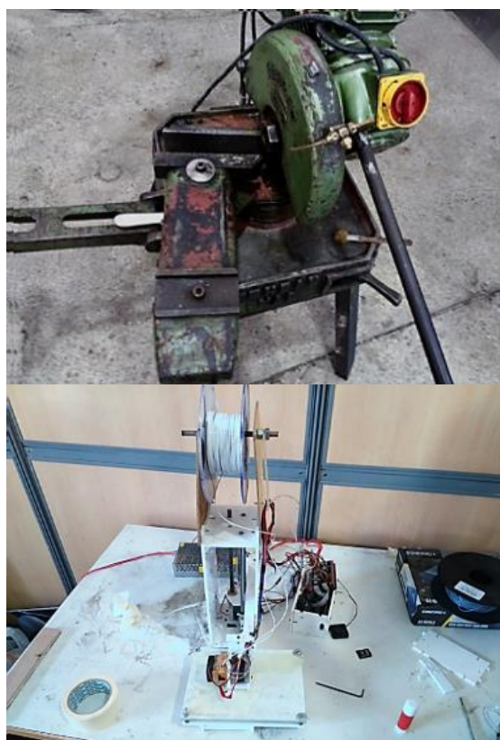
شکل ۱۶ - دستگاه برش مورد استفاده برای برش میله های المان کالیبراسیون سه بعدی (تصویر بالا) و پرینتر سه بعدی در حال پرینت اتصالات اصلی المان کالیبراسیون سه بعدی (تصویر پایین)
