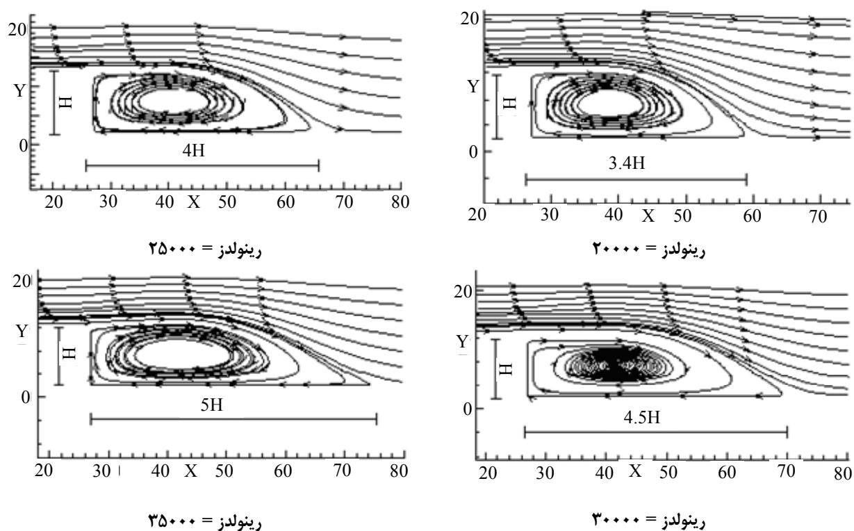
شکل ۹- جزئیات گردابه تشکیل شده بعد از بازشدگی در محدوده A برای اعداد رینولدز مختلف
