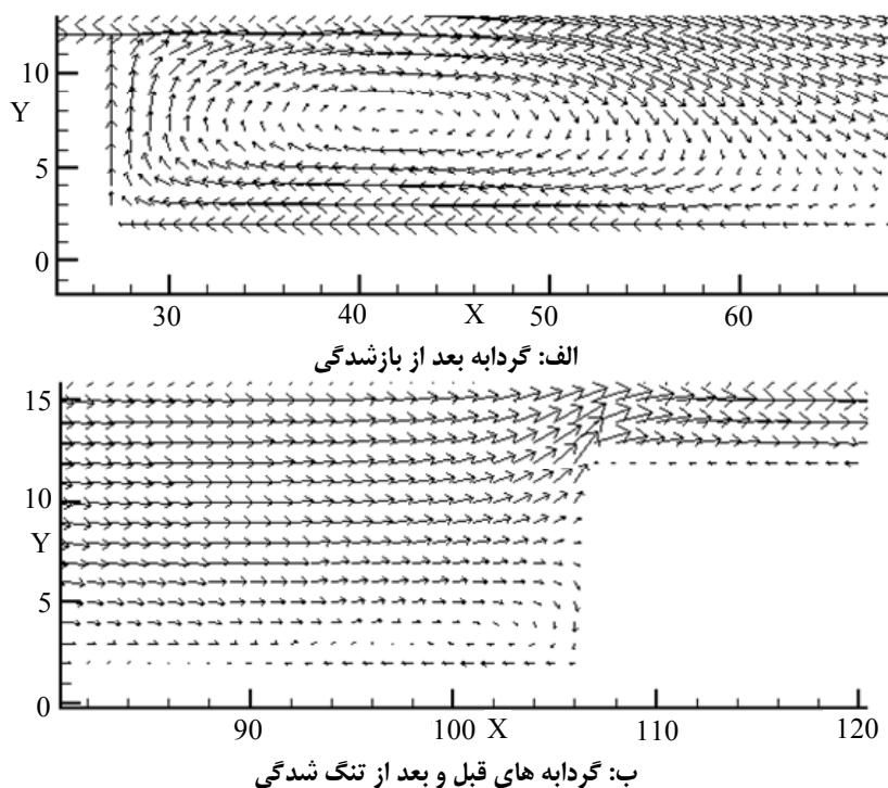
شکل ۸- تیپ پروفیل سرعت در محل تشکیل گردابه ها
