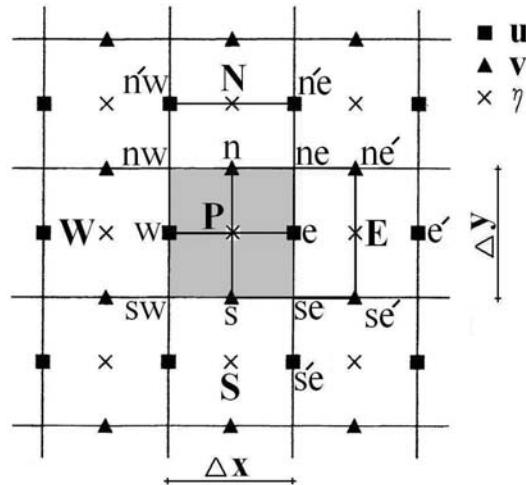
شکل ۱- شبکه متناوب و حجم کنترل معادلات پیوستگی و اندازه حرکت
