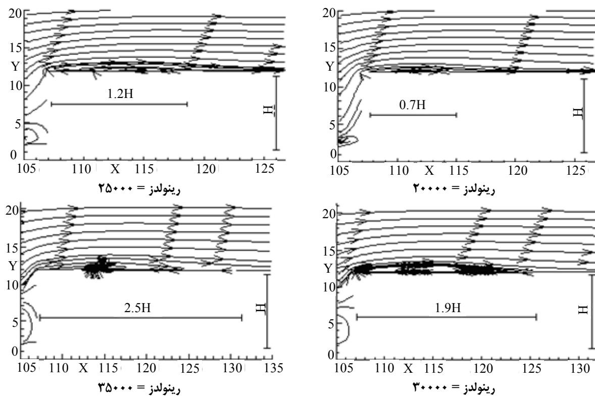
شکل ۱۱- جزیات گردابه تشکیل شده بعد از تنگ شدگی در محدوده C برای اعداد رینولدز مختلف
