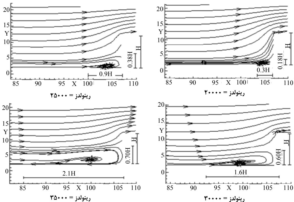
شکل ۱۰- جزیات گردابه تشکیل شده قبل از تنگ شدگی در محدوده B برای اعداد رینولدز مختلف
