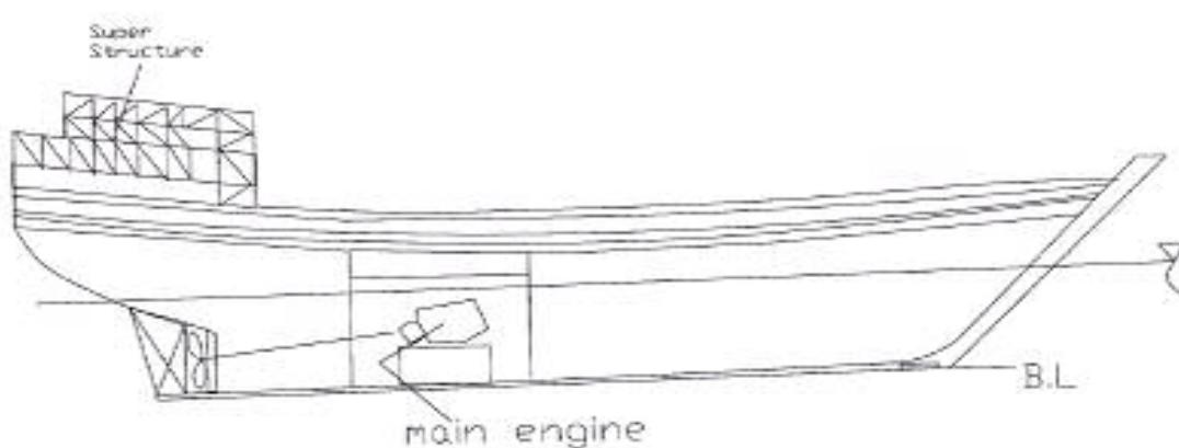
شکل شماره ۱ - جانمایی شماتیک یک لنج پاکستانی
