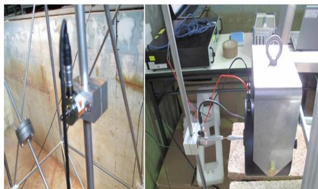
شکل ۲- ارتباط بین آمپلی فایر، لرزاننده الکترو دینامیکی، نیروسنج و سازه ی مدل
