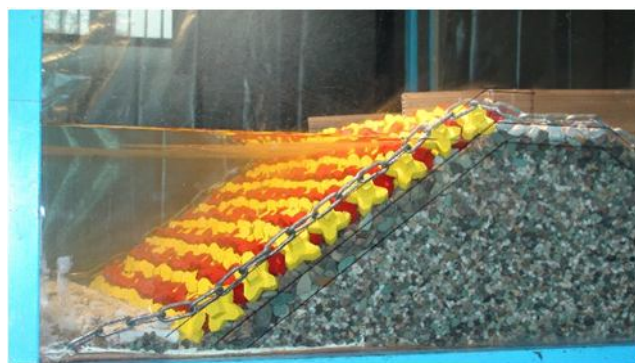
شکل ۱ - هندسه موجشکن ساخته شده در آزمایشگاه دانشگاه تربیت مدرس
