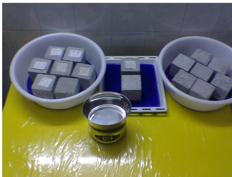
شکل ۱: قرار دادن نمونه‌های مکعبی داخل آب جهت تعیین جذب آب موئینه
