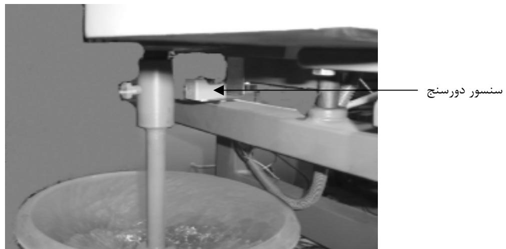
شکل ۱۰ - مجموعه دیسک و سنسور دورسنج دستگاه آزمایشی
