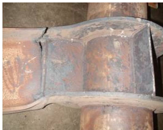
شکل ۱۳- نحوه گسیختگی اتصالات
