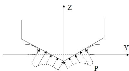
شکل ۱- شماتیکی از توزیع فشار در پدیده کوبش
