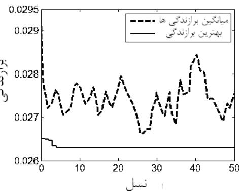
شکل ۶- روند پیشرفت برازنده‌گی کروموزوم‌ها در یک ورق چهار لایه نامتقارن با ابعاد  $1 \times 0.5 m$
