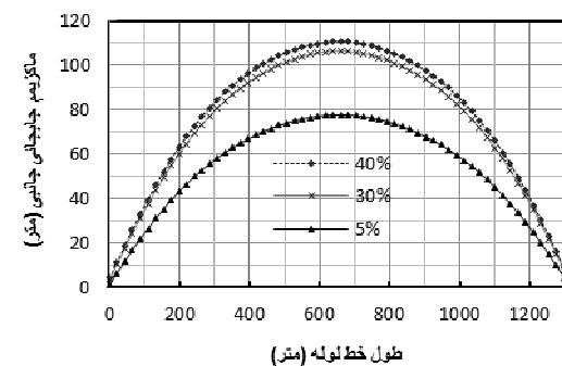
شکل ۸- ماکزیمم جابجایی جانبی خط‌لوله با طول ۱۲۰۰ متر برای ذخیره شناوری ۵، ۳۰ و ۴۰ درصد
