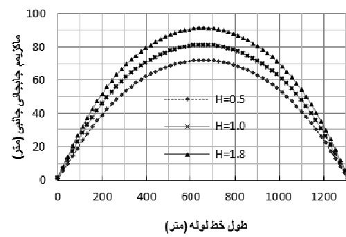
شکل ۵- ماکریم جابجایی جانبی خط‌لوله با طول ۱۲۰۰ متر ناشی از موج‌ها با ارتفاع ۰/۵، ۱/۰ و ۱/۸ متر
