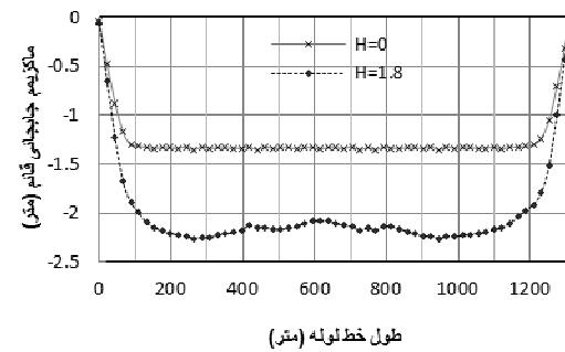
شکل ۱۰- ماکریم جابجایی قائم خط لوله با طول ۱۲۰۰ متر و سرعت ۵ کیلومتر بر ساعت برای دو حالت حضور موج و بدون آن
