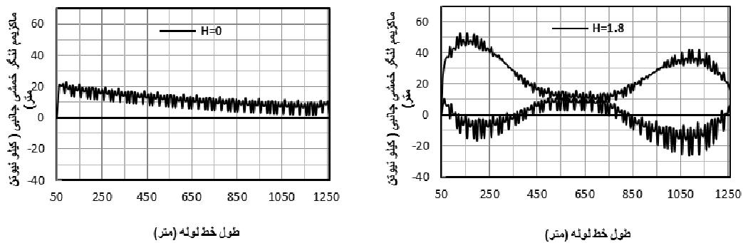
شکل ۱۱- ماکزیمم لنگرخمشی ناشی از انحنای جانبی در طول خط لوله به طول ۱۲۰۰ متر و سرعت ۵ کیلومتربر ساعت برای دو حالت حضور موج و بدون آن
