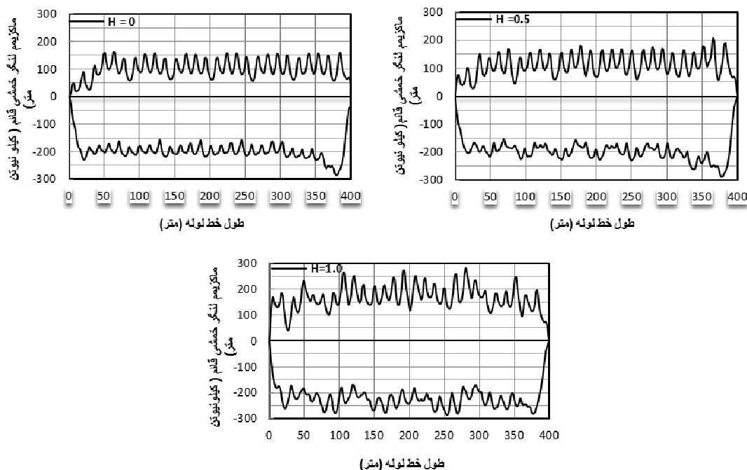
شکل ۱۵- ماکزیمم لنگرخمشی ناشی از انحنای قائم خط لوله با طول ۴۰۰ متر برای ارتفاع‌های ۰/۰ و ۰/۵ متری موج
