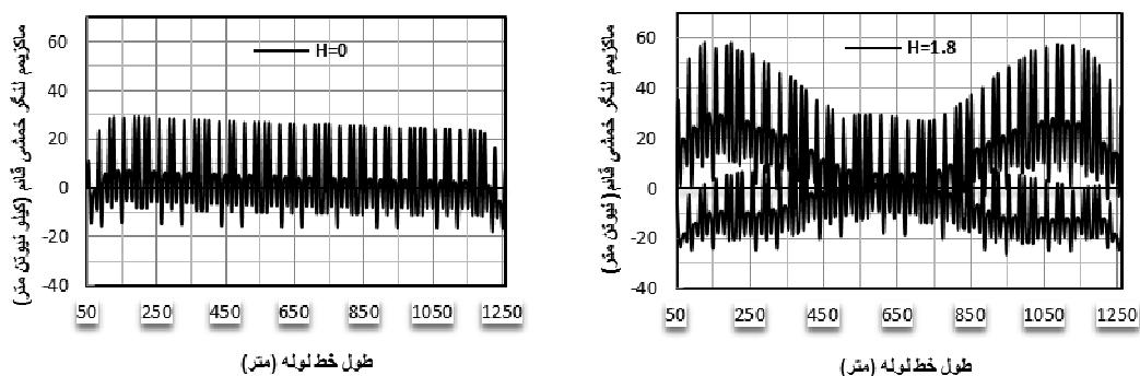
شکل ۱۲- ماکزیمم لنگرخمشی ناشی از انحنای قائم در طول خط لوله به طول ۱۲۰۰ متر و سرعت ۵ کیلومتربر ساعت برای دو حالت حضور موج و بدون آن
