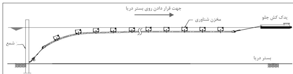
شکل ۱۴- قرار دادن خط‌لوله روی بستر دریا
