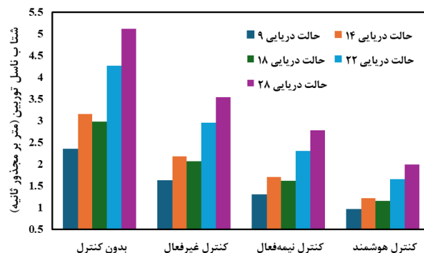
شکل ۶- شتاب ناسل توربین در روش‌های کنترلی مختلف
