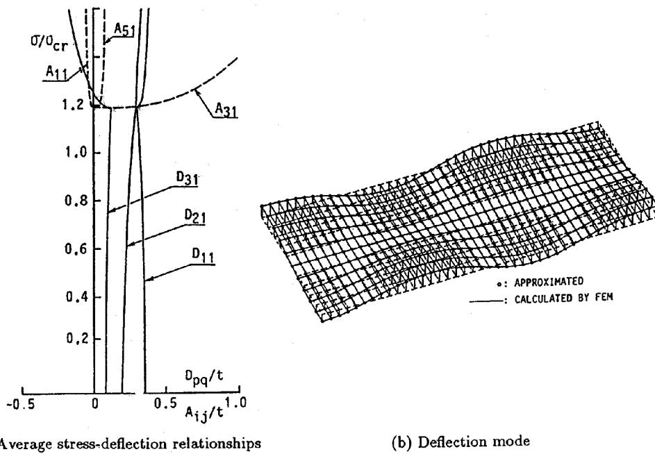
شکل ۳- مولفه های تغییرشکلی و مود کمانشی یک ورق ممتد از کف کشتی فله بر ، واقع در معرض ترکیب فشار جانبی و تنشهای درون صفحه ای طولی ( $h = 30 \text{ m}$ )
