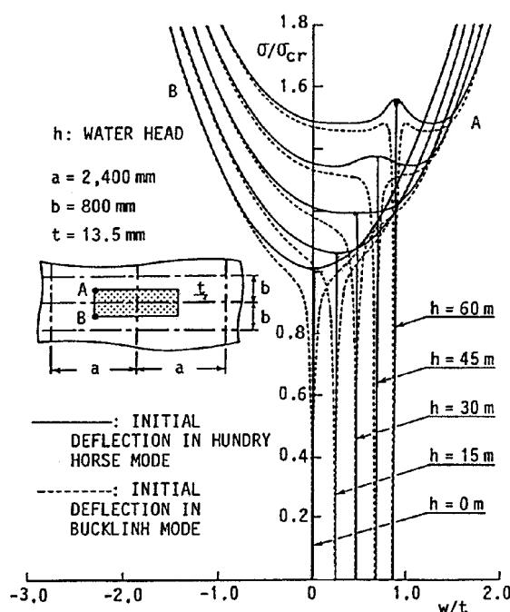
شکل ۲- رفتار کمانشی یک ورق ممتد از کف یک کشته فله بر قرار گرفته در معرض ترکیب فشار جانبی و تنش های درون صفحه ای طولی.
