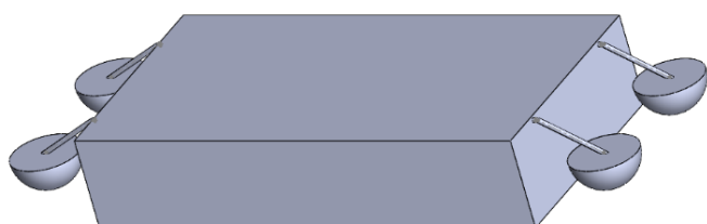
شکل ۷- نحوه قرارگیری مبدل‌ها در چیدمان ۱ (عرضی)
