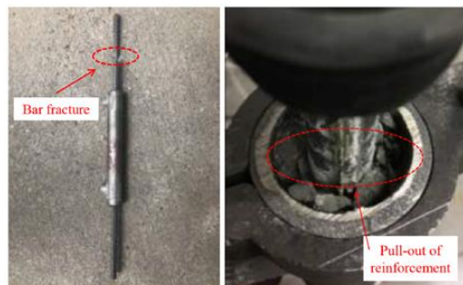
شکل ۲ - نمونه آزمایش انجام شده بر روی اتصال میلگرد به غلاف فولادی توسط بتن [۴]
