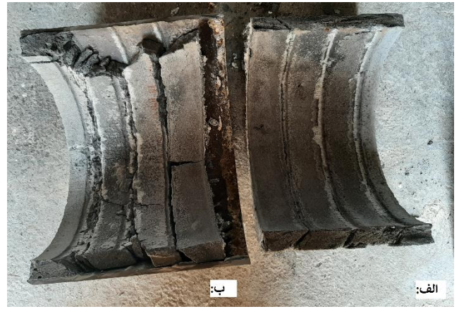
شکل ۱۳ - نمونه های پس از شکست بتن الیافی (ب) بتن بدون
