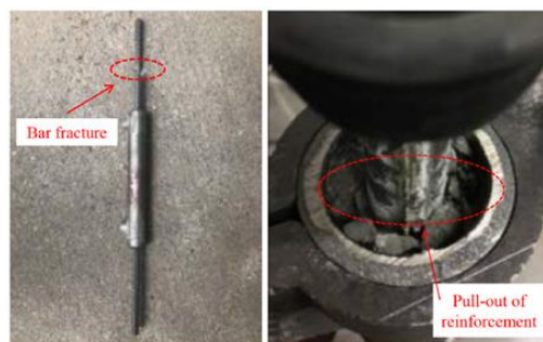
شکل ۲ - نمونه آزمایش انجام شده بر روی اتصال میلگرد به غلاف فولادی توسط بتن [۴]
