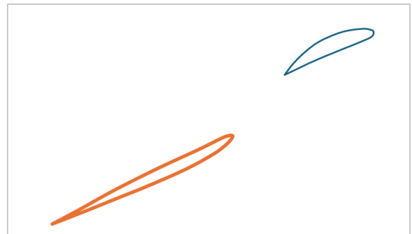
شکل ۸- پروانه Sharrow 1 مقطع A-A در 0.4 R
