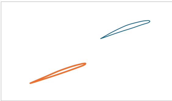
شکل ۱۳- پروانه Sharrow 2 مقطع B-B در 0.55 R
