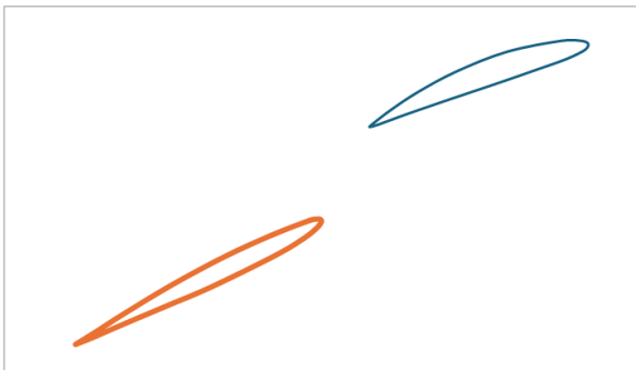
شکل ۱۲- پروانه Sharrow 2 مقطع A-A در 0.4 R
