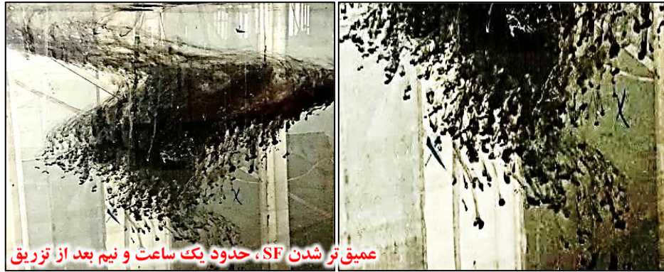
شکل ۴- شکل گیری انگشت نمک در مخزن آب شیرین
