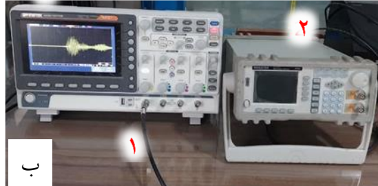
شکل ۱- الف) سنسورهای ارسال و دریافت سیگنال صوتی در مخزن آب شیرین و ب) دستگاه تولید و ثبت سیگنال صوتی
