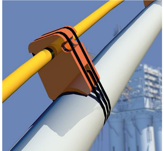
شکل ۱- لوله کوچک سوار بر لوله بزرگ (شماتیک)
