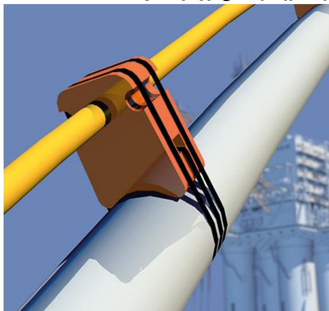
شکل ۱- لوله کوچک سوار بر لوله بزرگ (شماتیک)
