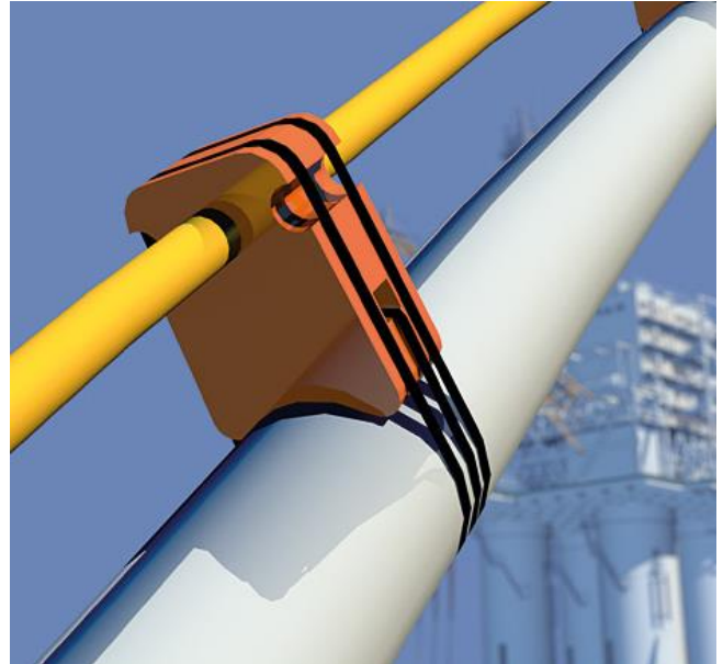
شکل ۱- لوله کوچک سوار بر لوله بزرگ (شماتیک)
