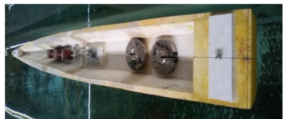
شکل ۵ - نحوه بارگذاری مدل در حوضچه کشش
