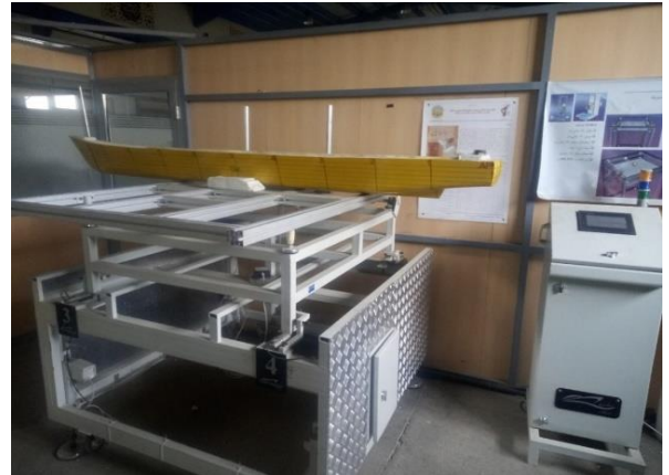
شکل ۳ - محاسبه مرکز ثقل مدل
