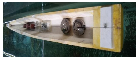
شکل ۵ - نحوه بارگذاری مدل در حوضچه کشش
