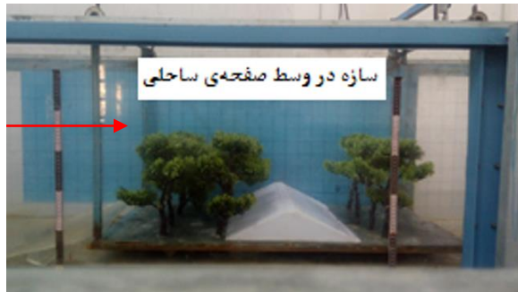
شکل ۱- نمای کلی از محل قرارگیری پوشش گیاهی جنگلی نسبت به سازه دیوار ساحلی - جهت جریان در شکل با فلش نمایش داده شده است.
