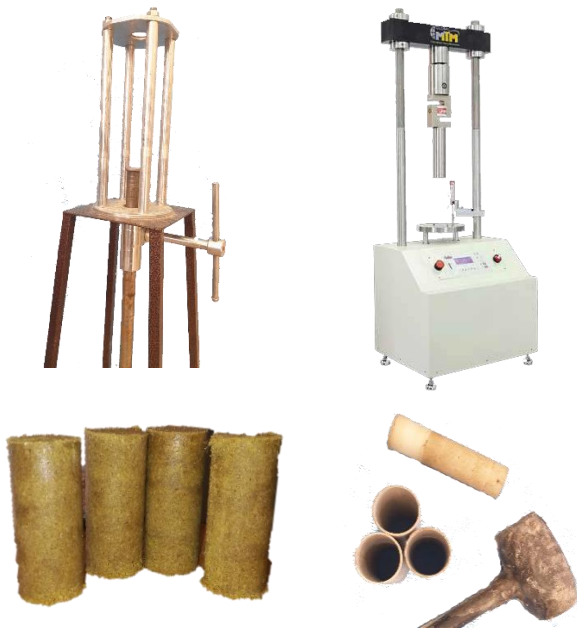
شکل ۳- وسایل لازم جهت ساخت نمونه و نمونه‌های ساخته شده
