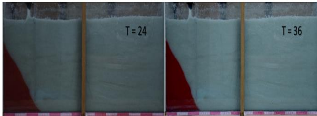
شکل ۱۲- روند بازگشت گوه آب شور با استفاده همزمان دیوار و چاه برداشت با نرخ استخراج ۰/۲ لیتر بر دقیقه در زمان‌های ۰، ۱۵، ۲۴ و ۳۶ دقیقه.
