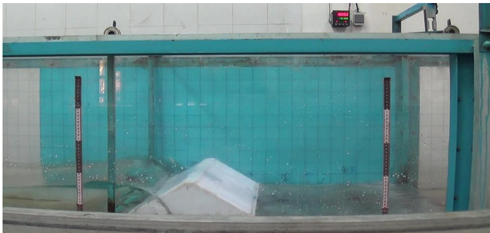
شکل ۴- نمایی از فلوم موج و دایک در آزمایشگاه هیدرولیک دانشگاه شهرکرد
