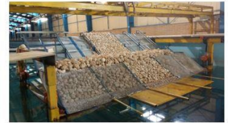
ج: لایه فیلتر و لایه نگهدارنده آرمور
