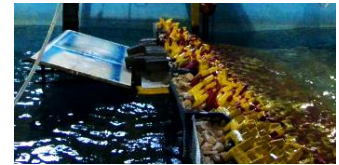
آزمایش شماره ۱۳ ( T_p=2.24 , H_s=32 , d=114 )
