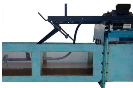
شکل ۴- نمایی از دینامومتر مورد استفاده به منظور اندازه‌گیری ضرایب هیدرودینامیکی تراست و گشتاور یک پروانه نیمه مغروق
