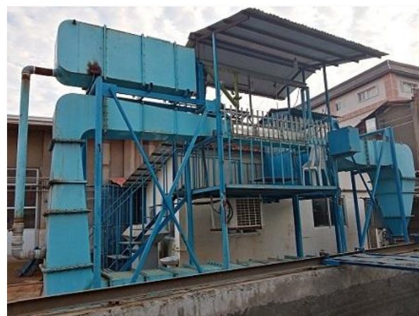
شکل ۲- نمایی از تونل آب سطح آزاد گروه انرژی‌های دریای پایه دانشگاه صنعتی نوشیروانی بابل
