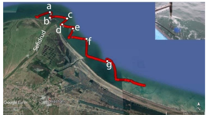
شکل ۱- مسیر حرکت شناور برای اندازه‌گیری جریان (پنل سمت چپ) و دستگاه ADCP متصل به شناور (سمت راست). ایستگاه‌های اندازه‌گیری پارامترهای فیزیکی آب و نمونه‌برداری آب با حروف انگلیسی نشان داده شده‌اند.
