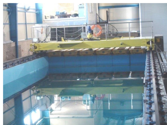
شکل ۳- موج ساز آزمایشگاه ملی دریایی شهدای خلیج فارس
