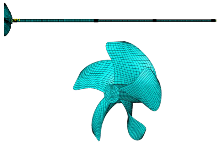
شکل ۱۵- مش ایجاد شده روی شفت و پروانه
