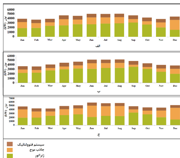
شکل ۱۸- سهم هر المان از توان تولیدی ماهانه در سیستم هیبریدی با استفاده از دستگاه جاذب موج: الف. پلامیس ب. ویودراگون ج. آکوابوی
