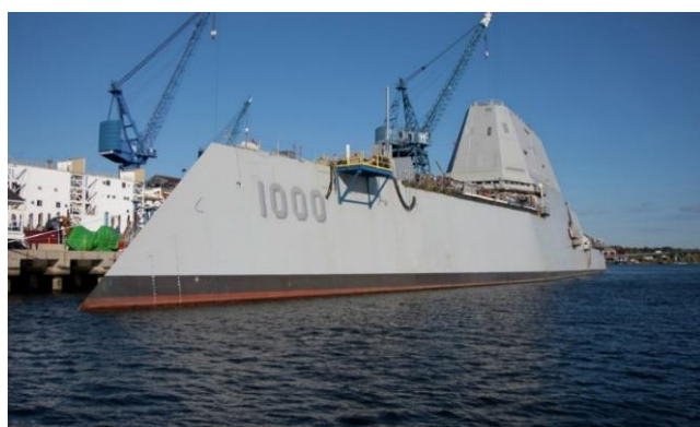
شکل ۱ - نمونه از شناور با فرم سینه مورب (رزمناو کلاس زومالت) [۵].
