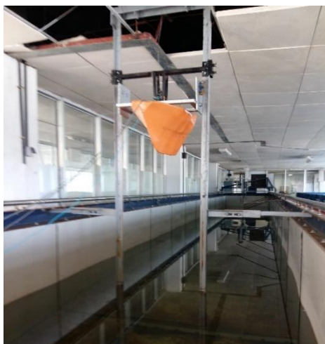
شکل ۶- نمایی از تجهیزات آزمایش به همراه مدل
