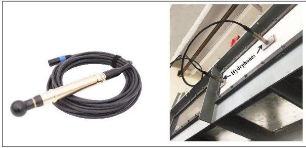
شکل ۱۴ - هیدروفون TC4042 و جانمایی تجهیزات تست
