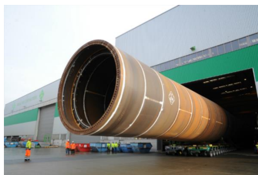
شکل ۱- نمونه مونوپایل ساخته شده با قطر ۷/۸ متر در مزرعه بادی وجامیت ۱ (آلمان) [۲]
