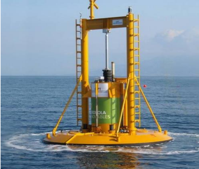
شکل ۱- مبدل جاذب نقطه‌ای OPT [۹]
