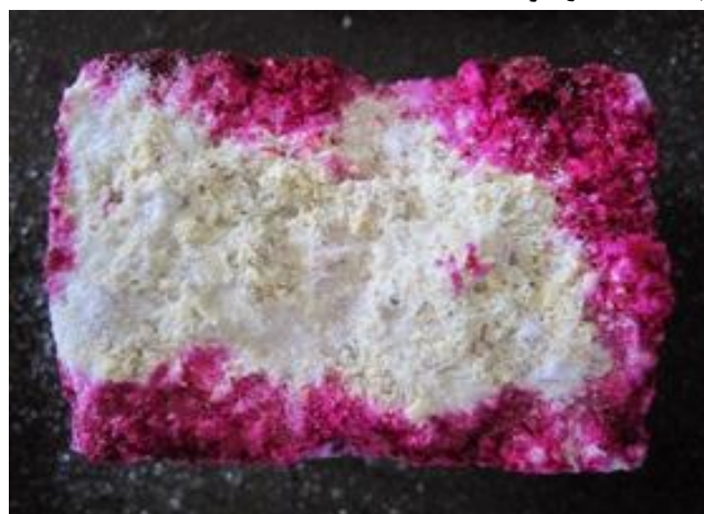
شکل ۳- سطح مقطع فنل فتالئین زده دو نمونه از سنگ لوماشل معدن هُگَر درگهان استحکام بخشی شده با آب آهک
