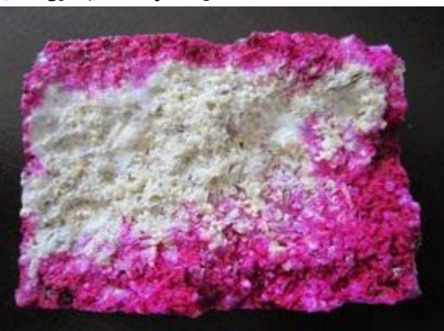
شکل ۳- سطح مقطع فنل فتالئین زده دو نمونه از سنگ لوماشل معدن هُگَر درگهان استحکام بخشی شده با آب آهک
