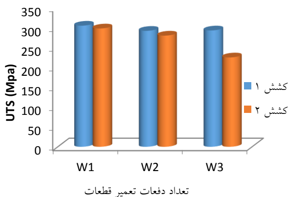
شکل ۲۳- نمودار استحکام کششی نهایی نسبت به تعداد دفعات تعمیر.
