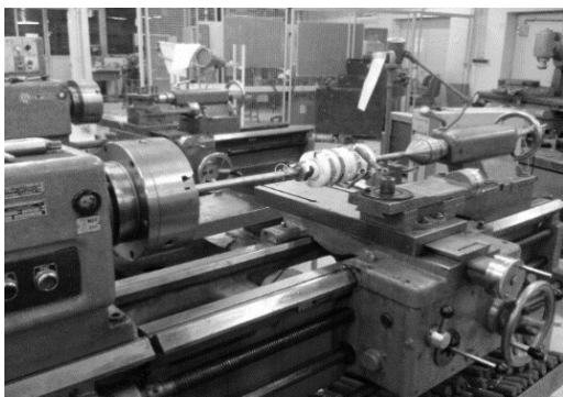
شکل ۲۱ - نصب سیستم اندازه‌گیری بر محور تعبیه شده بر روی دستگاه ماشین تراش TN40
