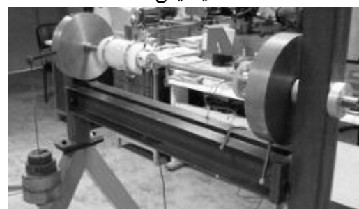
شکل ۱۷ - بارگذاری استاتیکی به منظور کالیبراسیون استاتیکی
