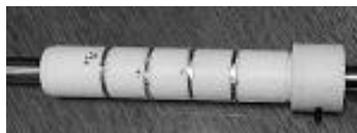
شکل ۱۰- رویه ی داخلی مجهز به ورقه‌های مسی
